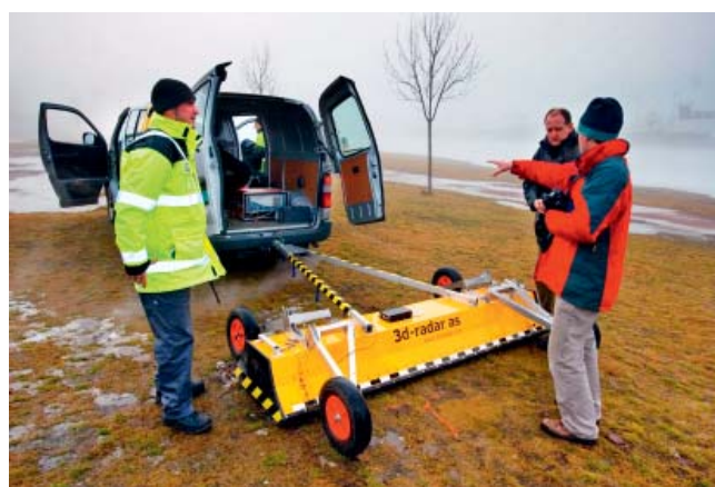
Fot. 3. 3D-RADAR norweskiej firmy Vmetro – system 32-antenny
